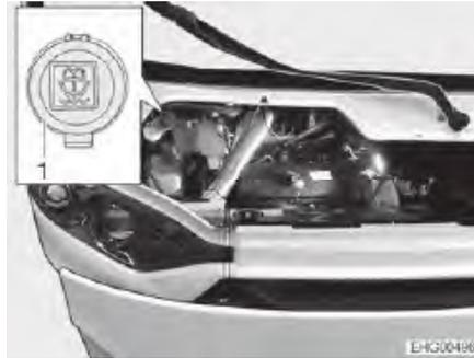
Bild 11 Einfüllstutzen (Scheibenwaschwasser)
