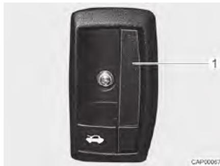
Bild 9 Entriegelungshebel (Motorhaube)
