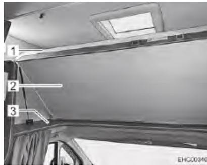
Bild 72 Alkovenbett in Fahrstellung
