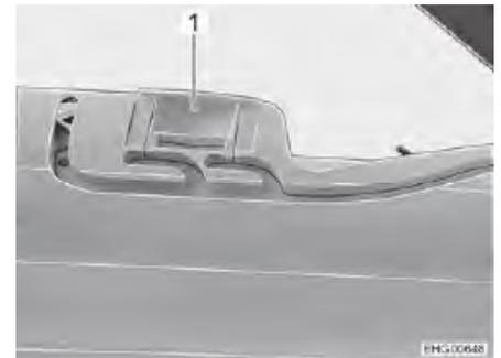
Bild 56 Verriegelung (Lüftungsstellung)
