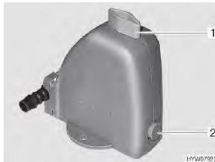
Bild 127 Sicherheits-/Ablassventil
