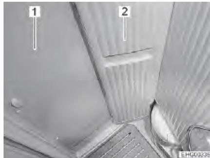
Bild 154 Kleine Schwenkwand, geschwenkt
