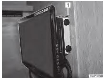
Bild 67 Flachbildschirm in Fahrtposition
