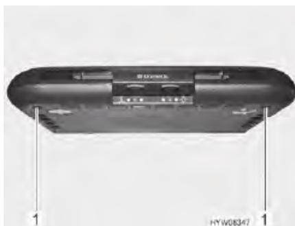
Bild 163 Untere Abdeckung abschrauben
