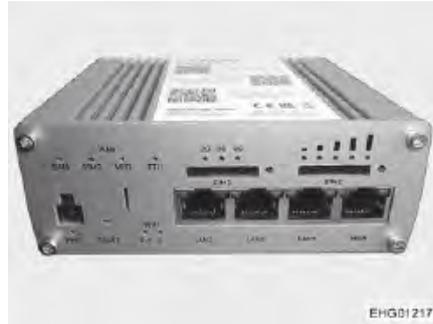
Bild 103 LTE-WLAN-Router
