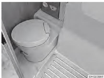
Bild 156 Toilettsitz, zur Wand gedreht
