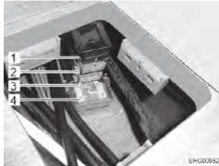
Bild 109 Sicherungen an der Wohnraumbatterie mit Lade-Booster (Ford)
