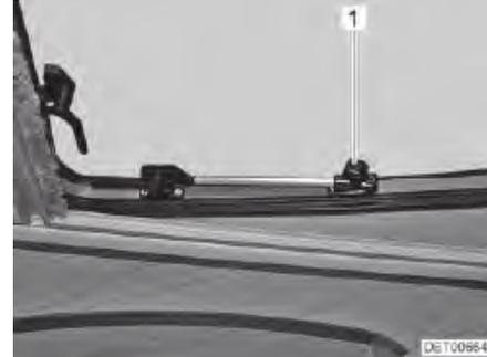
Bild 46 Dachfenster mit Dreh-Ausstellern, geöffnet
