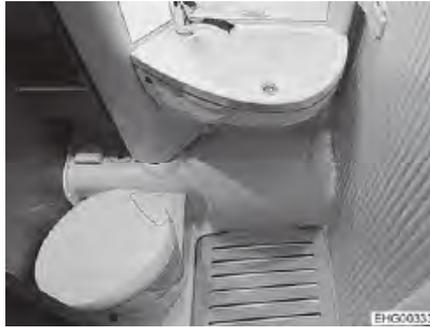
Bild 152 Toilettensitz, zur Wand gedreht
