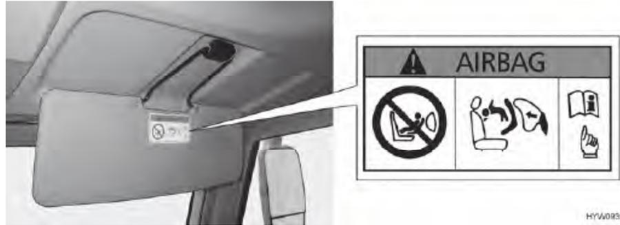
Bild 12 Warnhinweis Kinderrückhaltesystem (Beifahrersonnenblende)
